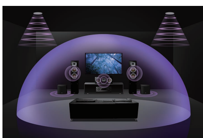
Système 3.2.2 avec enceintes encastrées au plafond
