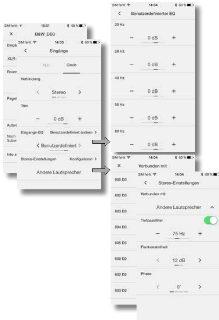
Stereo-Einstellungen: Einstellung des Tiefpassfilters bzw. Konfiguration.
