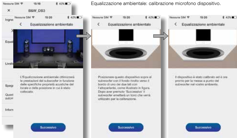
Equalizzazione ambientale: calibrazione microfono dispositivo.
