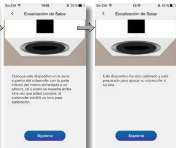
Ecualización de Salas (Room EQ): Calibración del micrófono del dispositivo móvil.
