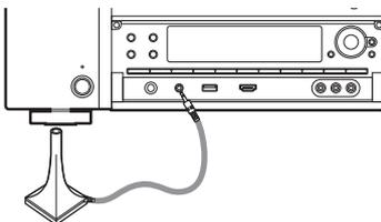
Lorsque le microphone de configuration et de mesure est connecté, l'écran suivant s'affiche.
