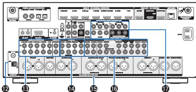
**12 Bornes d'antenne FM/AM (ANTENNA)**
