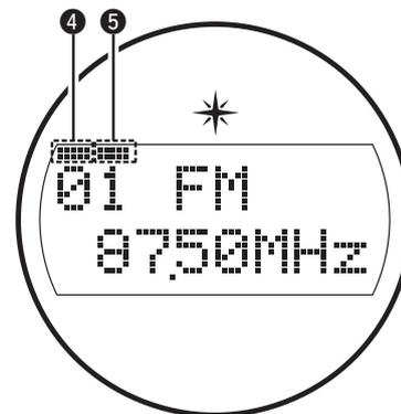
④ S'allume lorsque l'émission est correctement synchronisée.
