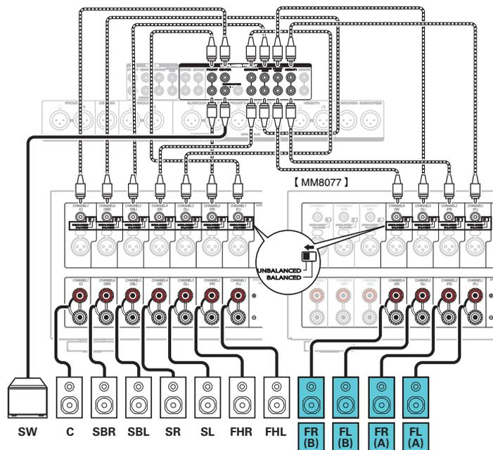
Les enceintes hautes, les enceintes au plafond et les enceintes Dolby Atmos Enabled peuvent être connectées sur les bornes d'enceinte HEIGHT1. Réglez les enceintes à connecter depuis "Hauteur" - "Agencement" dans le menu. ( p. 233)
